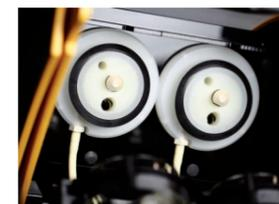
✦ Prima di ogni processo di lavaggio, i filtri a pieghe vengono bagnati con acqua. Ciò assicura che il filtro sia pronto per trattare tutto il campione idrolizzato e non rilasci frammenti di carta.
