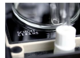
✦ La fornitura di energia alla piastra di riscaldamento può essere regolata tramite software a ogni processo, in modo da creare condizioni di gestione ottimali.
